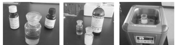
超音波洗浄機で酸化チタン粉末を分散させました。<sup>6-参考文献3)</sup>(写真右)。
