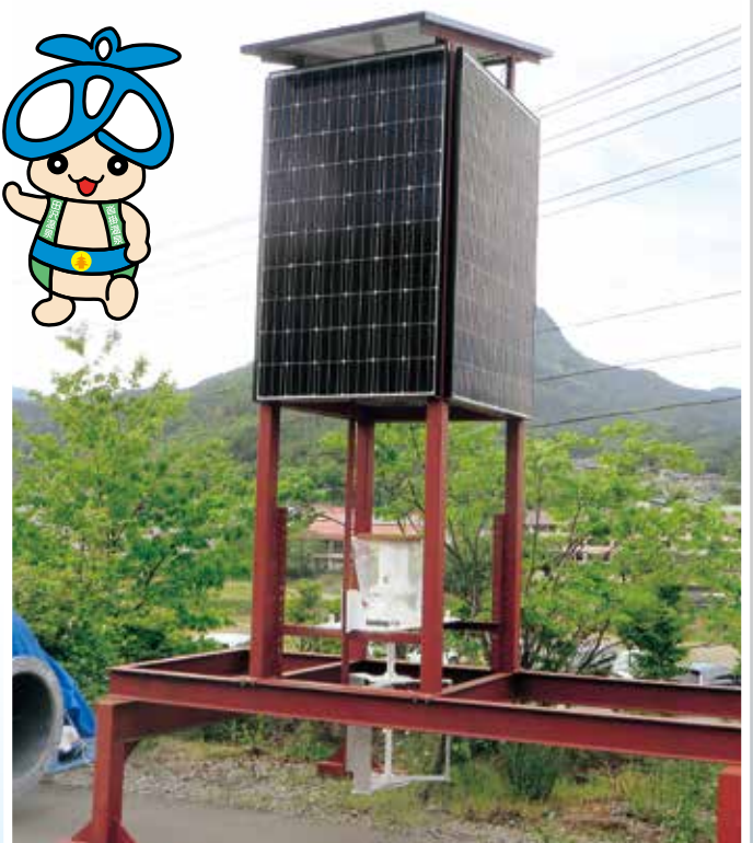
小水力・太陽光を組合わせた第2号試作機
