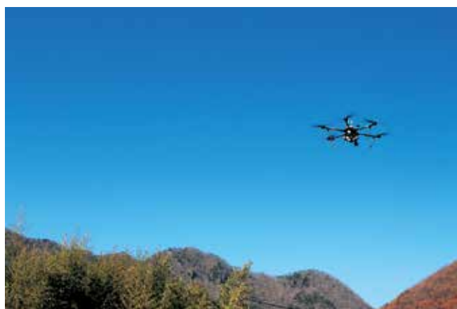
最新技術を用いたドローンによる測量（UAVレーザースキャナー測量）の様子
