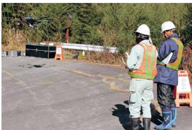
最新技術を用いたドローンによる測量（UAVレーザースキャナー測量）の様子
